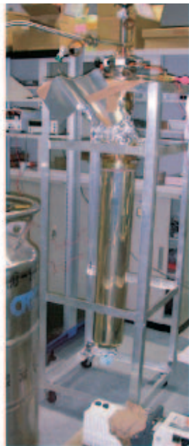
図 3: 本実験用に建設した ^4\text{He} evaporation crumstat
