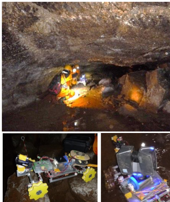
図8. (上)レーザースキャナー計測 (下左) ローバー(有線式) (下右) レーザースキャナーFARO 社製 Laser Scanner Focus3D
