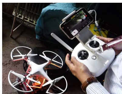
図10 ドローンとコントローラー (DJI社 Phantom2)
