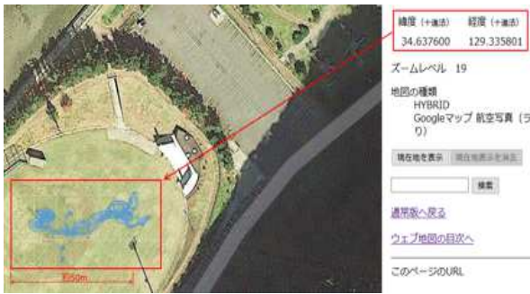
図6 GPSより取得した経度と緯度座標とそれに対応した地図データ (Google マップ参照)
