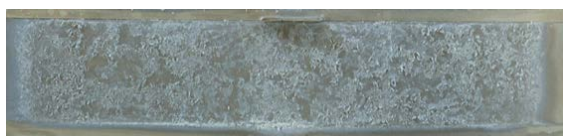
写真1. 24時間電解後の陰極表面の外観写真
