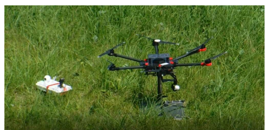
画像 20 UGV の空中輸送・着陸後探査・回収帰還実験
