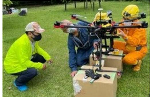
図 13 レーザースキャナ装置搭載ドローン(DJI のドローン Matrice600 の上部と下部のジンバルに分けて取り付けられている)
