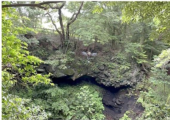
図 15 レーザースキャナ装置搭載ドローンの降下進入
