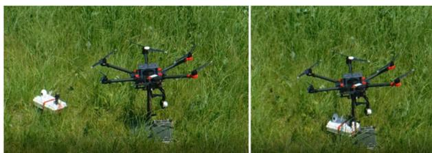
図23 ドローンによる地上走行ロボットの空中輸送
