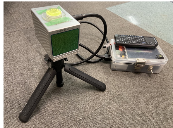
図 20 小型 LiDAR の携行型装備
