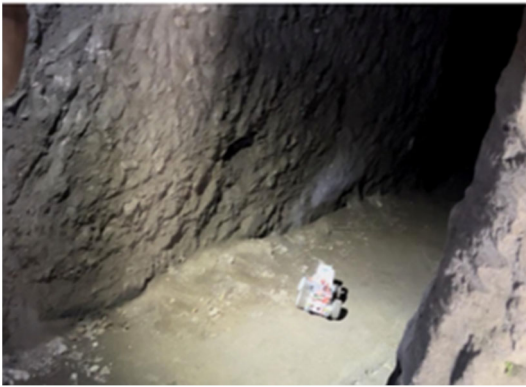
図 16 斜路を移動するテスト用 UGV (上：上り、下：下り)
