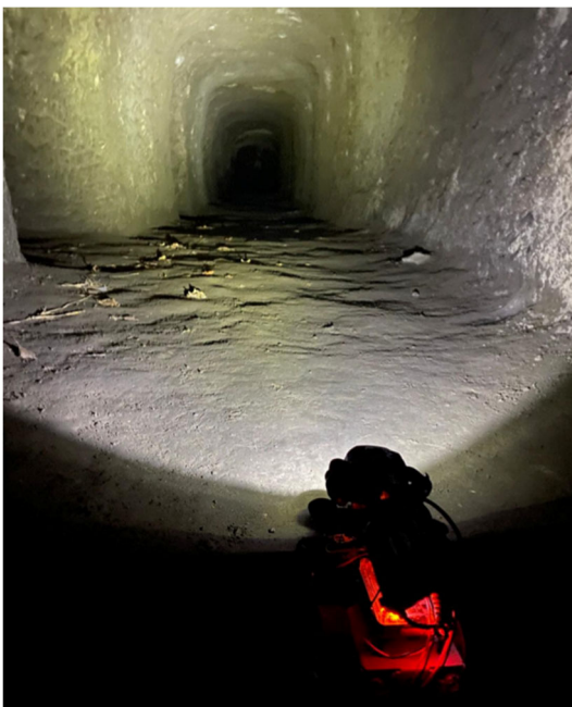
図 17 横穴を移動するテスト用 UGV
