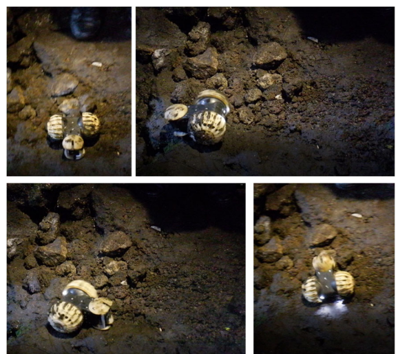
図 9 小型ロボットの洞床走行実験 「YAOKI™」(株)ダイモン
